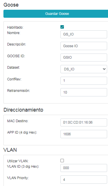
Figura 5-27: Interfaz WEB - Configuración de GOOSE
