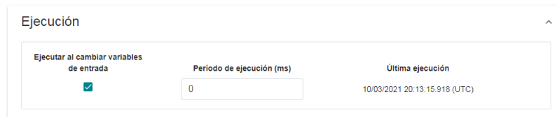
Figura 5-37: Interfaz WEB - Modos de ejecución de la lógica
