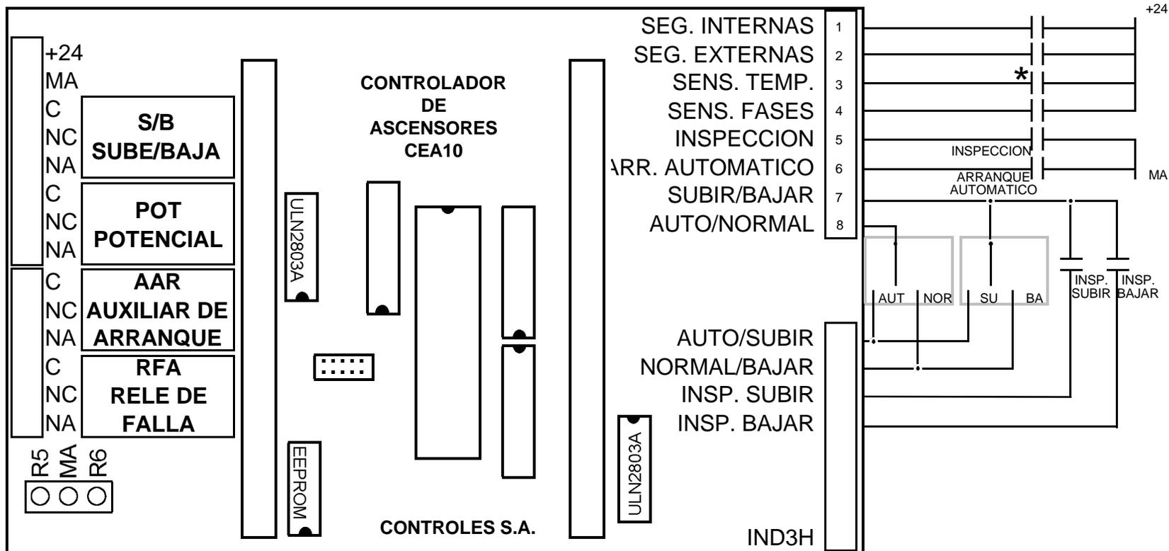
Los bornes 1 a 4 tienen retorno interno de 10 Kohm a MA
